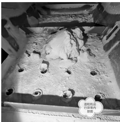
图2 造粒机运行故障图
