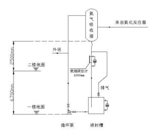
改造后效果:通过此次改造后,正常生产过程中 氨水循环泵出口阀可正常全开,达到设计循环量。 液位可通过自调阀进行稳定控制,但由于改造后真 实液位只有下液管道内液体量,缓冲余地较少,倒泵 操作时需谨慎。
