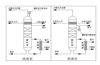
改造后效果:经过改造后,彻底解决了解析塔压 力导压管堵塞现象,压力表指示值较之前基本无差 别,解析系统实现稳定运行。
