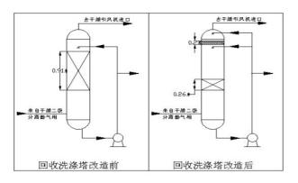
改造后运行效果:改造后通过测量引风机出口风量由原先的7300 m³/h提升至9300m³/h,风量增大后整个干燥系统运行周期由原先一周延长至运行20天左右,班产托品量由原先10吨左右提至16吨。干燥系统风箱内积料也有所好转。
