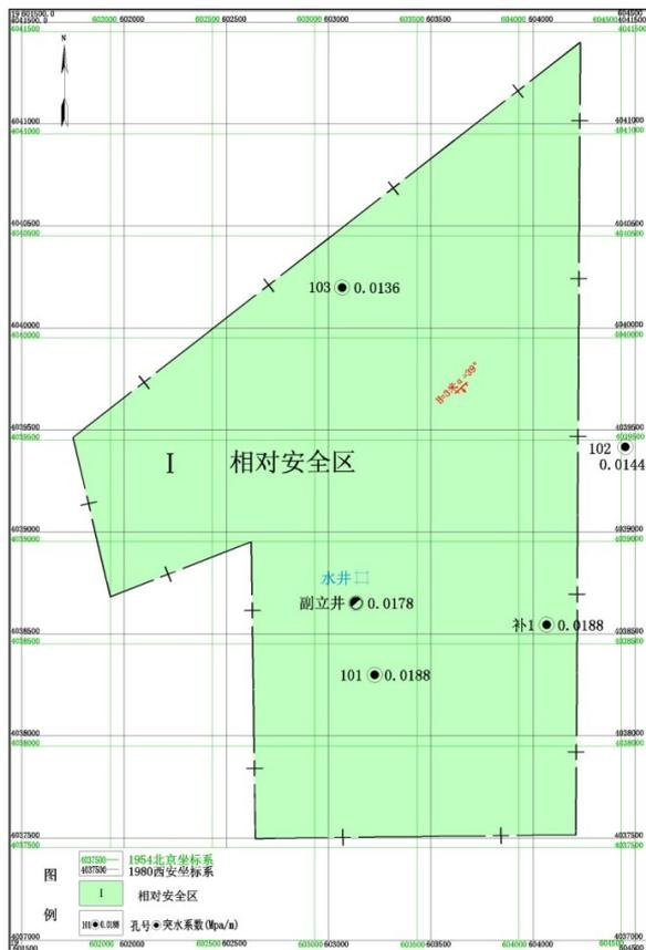
图1 3号煤层带压开采分区图
